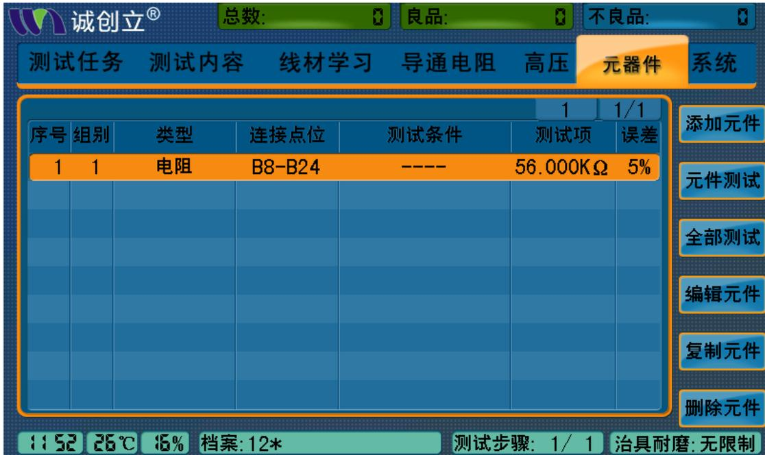
为防止连接点位在输入过程中出错，请在完成添加后，按下【F3】{元件测试}，检查当前编辑参数是否正确。**(注意：需连接产品与治具在测试机端口，测试项中电阻值显示红色为错误)**
