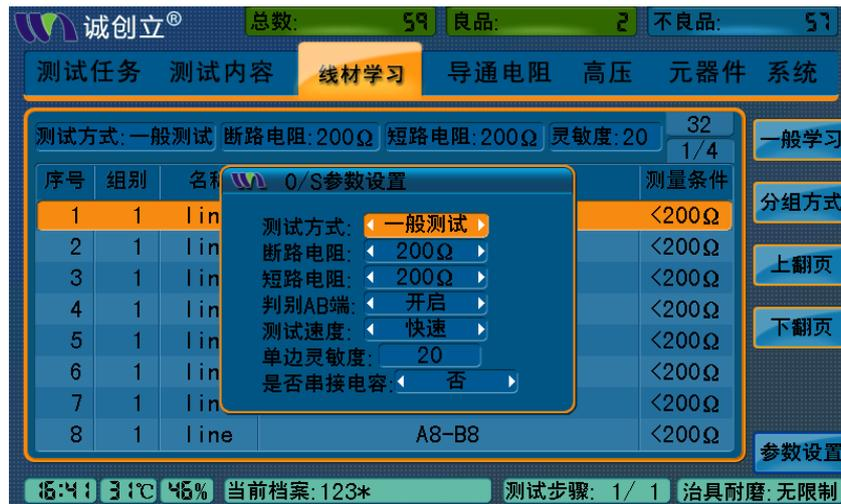
(3) 将待测产品样品接入测试治具，然后按【F1】键，设备会自动读取线材网路。我们可以通过【F3】和【F4】键查看线材网路是否正确。确定正确后按【Save】键将读取的网路保存到当前档案。
