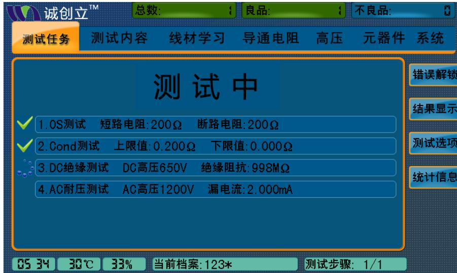
测试过程完成后，屏幕会提示测试结果。若显示“良品”，表示线材通过本档案设定的测试条件，同时显示测试耗时时间。请拔出线材，重新接上待测线材，按【TEST】键继续测试任务。拔出线材后，屏幕顶部的总数、良品、不良品数据会更新。
