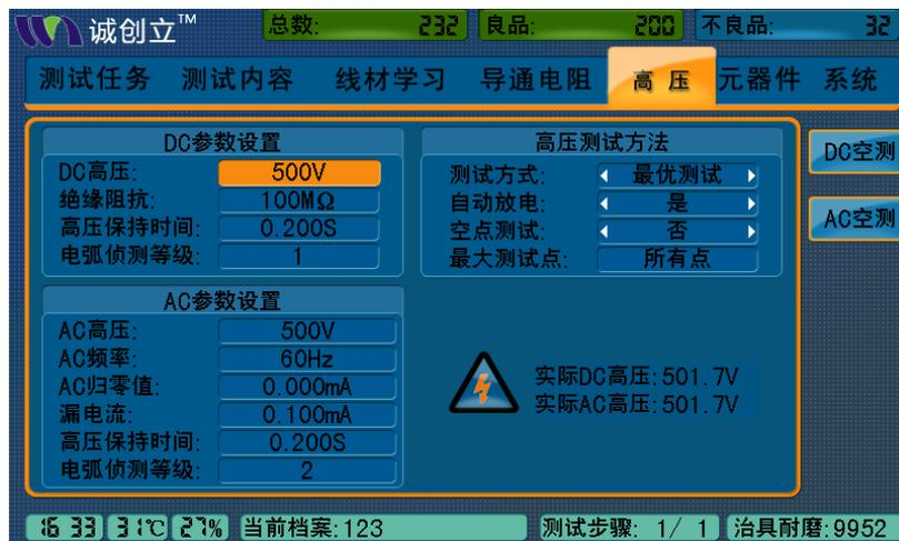
说明。若实际值与设定值误差较大, 需进行高压校准, 方法见“系统菜单设置”中关于DC、AC校准的说明。
