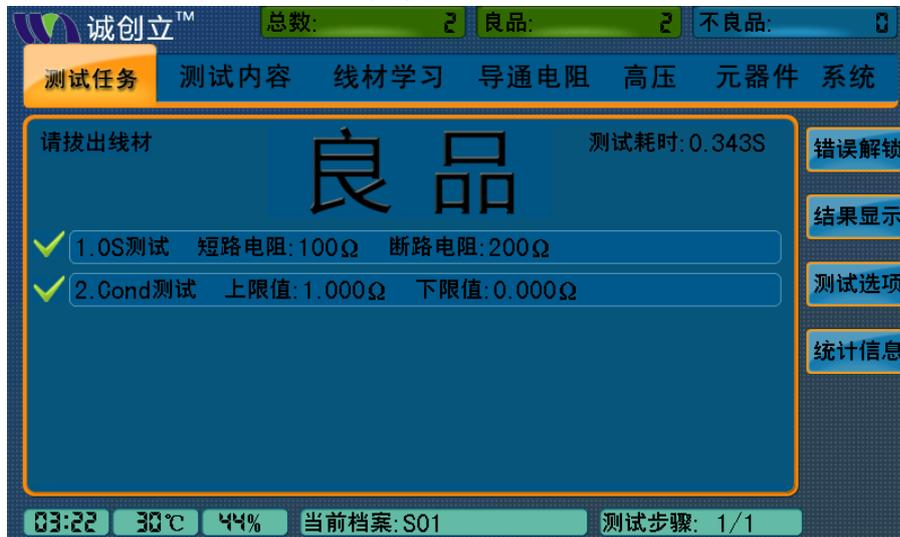
(2) 错误解锁：为了更好的进行品质管理，当测试的线材不良品数量超过预设时，测试机将锁住，不能继续测试（【TEST】按键无效）。需相应的管控人员解锁才行，按<错误解锁>【F1】，输入正确密码即可。
